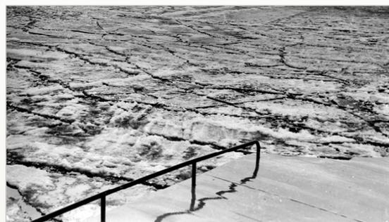
Характер разрушения ледяного покрова ДКВП «Мурена».
