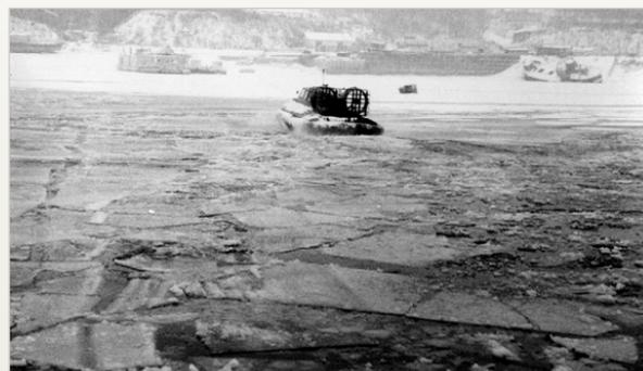
Разрушение льда СВП «Гепард» (вес судна 1,8 т., толщина льда 8-10 см.)
